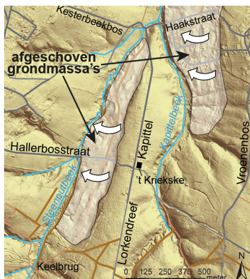
Figuur 5. Schaduwbeeld van het reliëf rond het Kapittel. In witachtig: afgeschoven grondmassieven.
